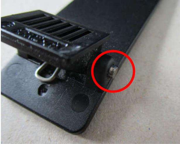
Uns liegen einige Meldungen vor, dass sich im laufenden Betrieb ein Metallstift des Gürtelclips der Pager seitlich herausdreht.
